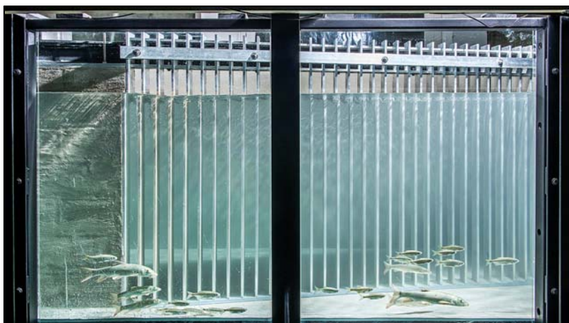
Bild 3: Modellversuche mit Lebendfischen (VAW)
