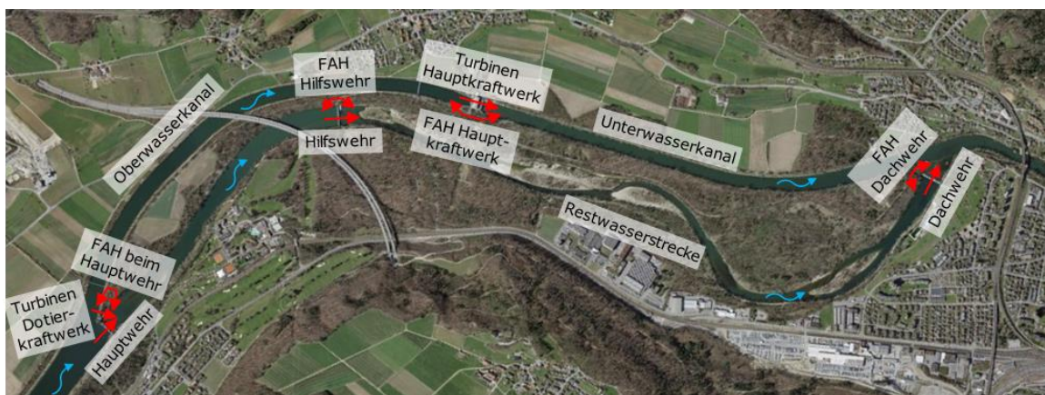
Abb. 3.4 Übersicht des KWWB, wobei die potenziellen Wanderkorridore mit roten Pfeilen dargestellt sind (FAH: Fischaufstiegshilfe; Quelle Orthofoto: Swisstopo).
