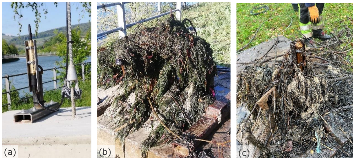
Abb. 7.2 (a) Ein mit einer Metallhalterung an einem Betonklotz befestigtes Hydrophon vor der Installation, (b) das am 23. April 2021 mit dem Pneukran gehobene Hydrophon Nr. 14 mit abgebrochener Antenne und (c) das erneuerte Hydrophon Nr. 14 mit ebenfalls abgebrochener Antenne während des Rückbaus am 31. Oktober 2022.
