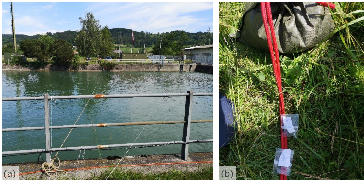
Abb. 4.10 (a) Über den Oberwasserkanal gespanntes Seil und (b) der Test-Tag, welcher durch einen mit Steinen befüllten Sack beschwert wurde.
