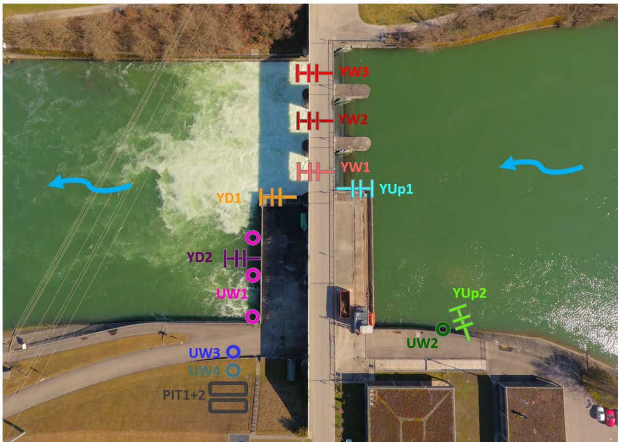
Abbildung 13: Übersicht der Anordnung der Antennen. UW3, UW4 und PIT1+2 befinden sich in der Fischaufstiegsanlage. Linksufrig: Maschinenhaus. Rechtsufrig: Wehranlagen
