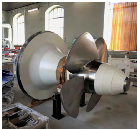
Die neuen Turbinen vor dem Einbau im Januar 2022.
