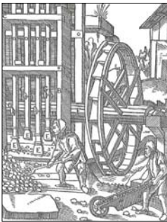
Oberschlägliges Wasserrad zum Antrieb einer Erzstampe in Basel nach Kupferstich aus dem 16. Jh.
