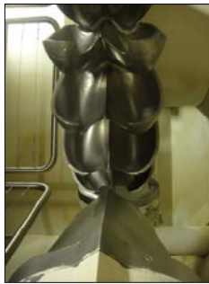
Fünfstrahlige Vertikal-Pelton turbine zur Stromproduktion der FM Gouggra in Chippis/VS im 21. Jh.
