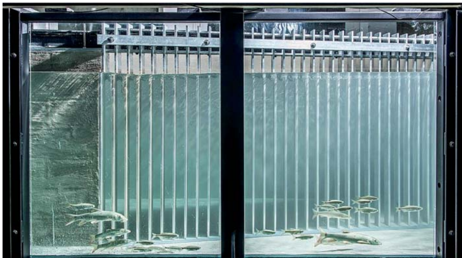
Bild 2. Modellversuche mit Lebendfischen vor der Leiteinrichtung (Foto: VAW, 2013).
