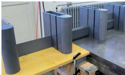
Bild 3. Fertigung der Wehranlage aus PVC (Foto: VAW-ETHZ).
