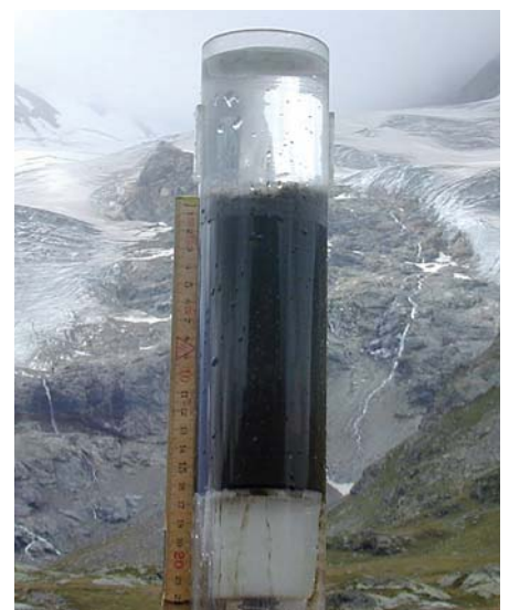
Bild 1. Sedimentkern für die Bestimmung des Methangehaltes bei Lej Nair vor dem Cambrenagletscher am Bernina-Pass, Graubünden. (Foto: Ch. Bigler)
