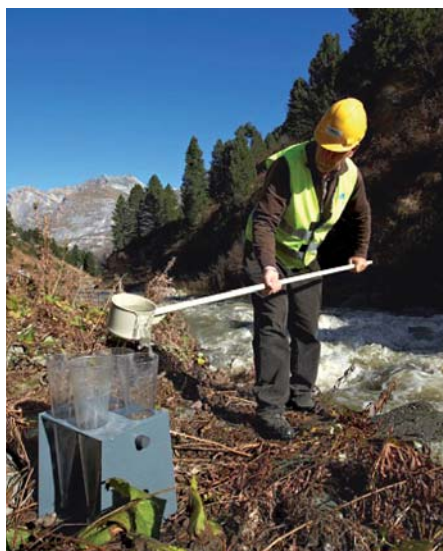
Bild 2. Ecowert misst die Schwebstoffe im abfliessenden Wasser mehrmals täglich.
